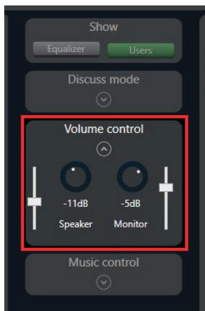
Permet de modifier le volume des sorties audio du système :
