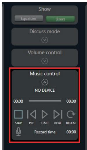
Ce logiciel vous permet de contrôler la lecture ou l'enregistrement du périphérique USB connecté sur le panneau avant.
