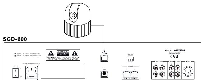
Existem 2 tipos de ligação: suporte direto do protocolo PELCO-D diretamente (RS-485); e protocolo VISCA (necessita de um conversor de RS-485 para RS-232).
