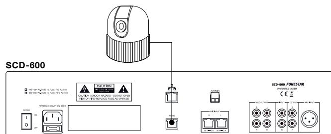
Existen 2 tipos de conexión: soporte directo del protocolo PELCO-D directamente (RS-485); y protocolo VISCA (necesita un convertidor de RS-485 a RS-232).
