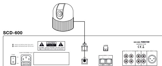
Il existe 2 types de connexion : le support direct du protocole PELCO-D (RS-485) ; et pour le protocole VISCA (il faut un convertisseur RS-485 vers RS-232).
