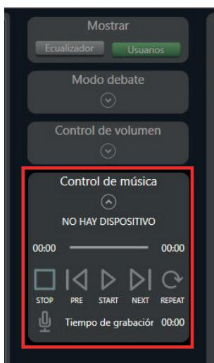
El software permite controlar la reproducción o grabación el dispositivo de USB conectado en el panel frontal.
