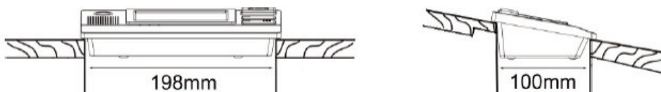
Figura 4 Diagrama esquemático de la creación de una ranura para colocar el ZS-200M (superficie plana)
