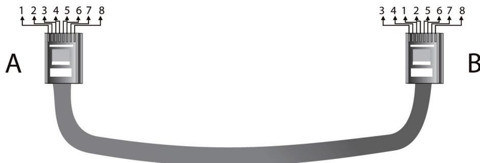
Le câble pour la connexion du microphone avec la centrale de megaphonie ou de plusieurs microphones en cascade doit se réaliser avec un câble de Cat 5e ou Cat 6. Ce câble comprend 8 conducteurs qui doivent être connectés selon le schéma antérieur et finalise à chaque extrême avec des connecteurs RJ-45 (8P8C).
