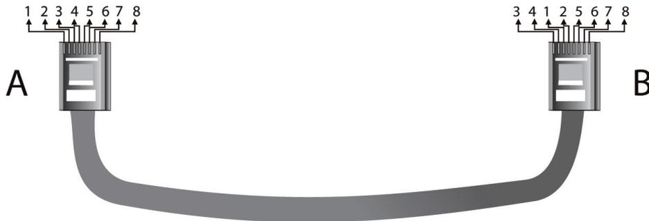
El cable para la conexión del micrófono con la central de megafonía o de varios micrófonos en cascada debe realizarse con cable de Cat 5e o Cat 6. Este cable consta de 8 conductores que deben ser conectados según el esquema anterior y terminado en ambos extremos con conectores RJ-45 (8P8C).
