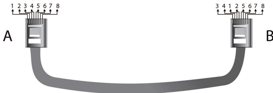
O cabo para ligar o microfone à central de megafonia ou de vários microfones em cascata deverá ser um cabo Cat 5e ou Cat 6. Este cabo possui 8 condutores que devem ser ligados segundo o esquema anterior e terminado em ambas as extremidades com conectores RJ-45 (8P8C).
